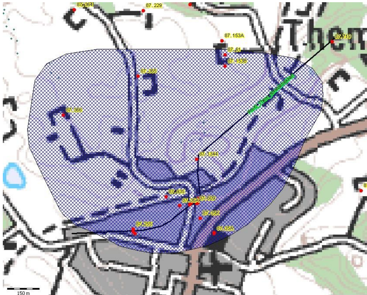
Figur 5.1 Børinger og indvindingsopland omkring Them Vandværk, Smedebakken. Børinger er angivet med en stor rød prik og DGU nr. Det skraverede område er indvindingsoplandet. Den sorte linje viser forløbet af profilsnittet på Figur 5.2. Legende med farvekode kan ses i bilag 8.3.
